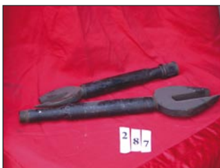
Grandes pinces homard sciées en deux et transformées en pas de vis pour entrer dans la trousse d'un forceur de coffre.
